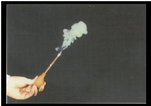
Abb. 15: Aufgesägtes Glasröhrchen; durch Drücken auf den Gummiball wird Rauch sichtbar gemacht
