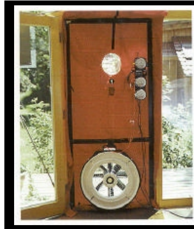
Abb. 9: Die Blower Door – komplett in 15 Minuten installiert
